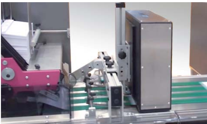
Vakuumband an der Gutzuführung
