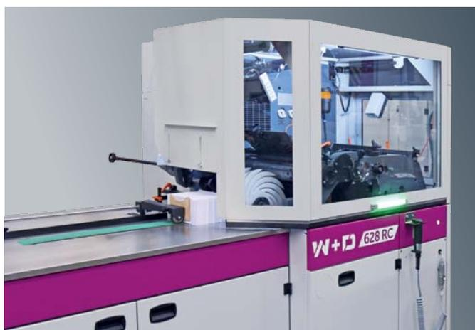
Lärmschutzverkleidung mit großen Fenstern zur Beobachtung des Produktionsprozesses
