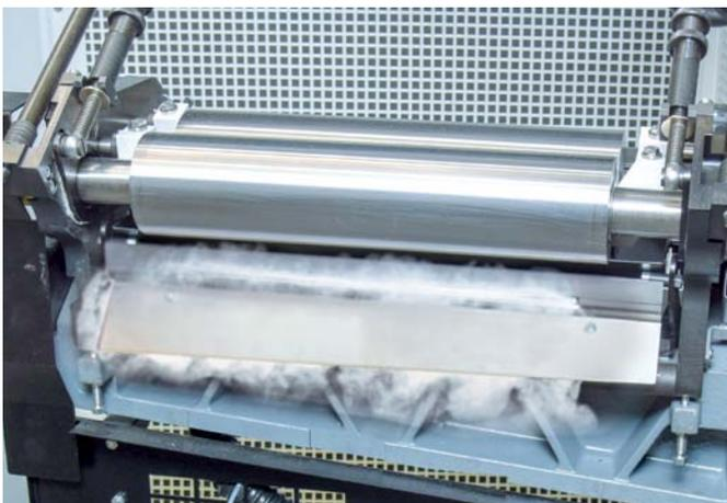
Schlußklappengummierwerk mit Leimbefeuchtung
