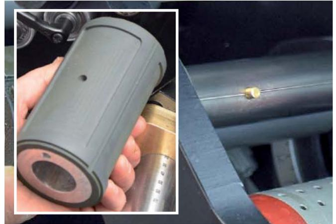
Werkzeuglose Positionierung des Fenstergummierers mittels PIN-Systems
