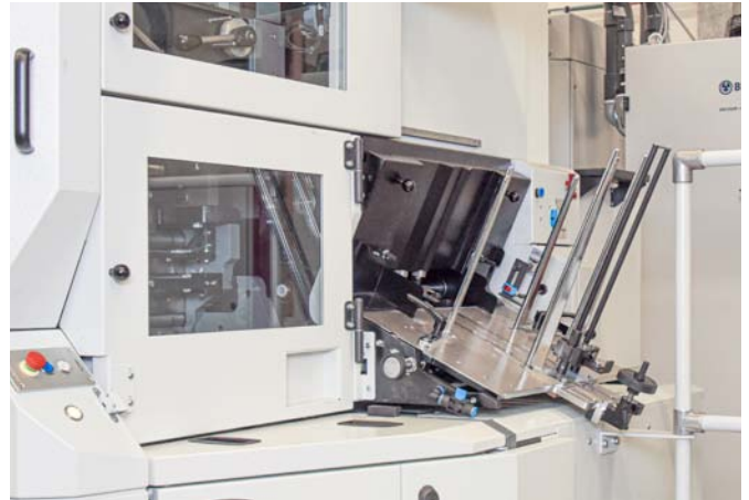
Rollenproduktion – Blatteinzug in Stand-by Position
