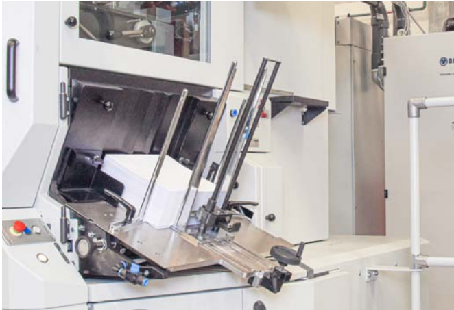
Blattproduktion – Blatteinzug in Arbeitsposition
