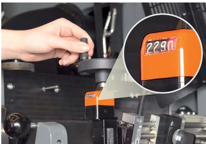
Schnelle und einfache Anpassung des Kuvertformats durch integrierte Einstellhilfen und Skalen
