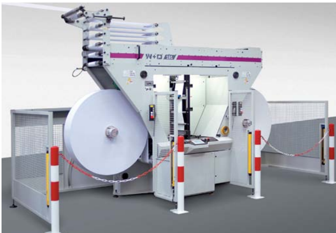
Automatischer Rollenwechsler W+D 191
