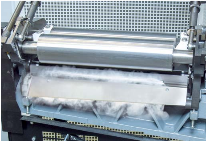
Schlußklappengummierwerk mit Leimbefeuchtung
