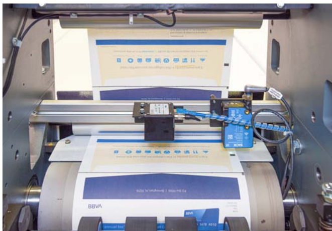
Intelligente Kamera im Rolleneinlauf im Schneidturn
