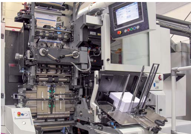
Schneidturn mit Station für Trennschnitt
