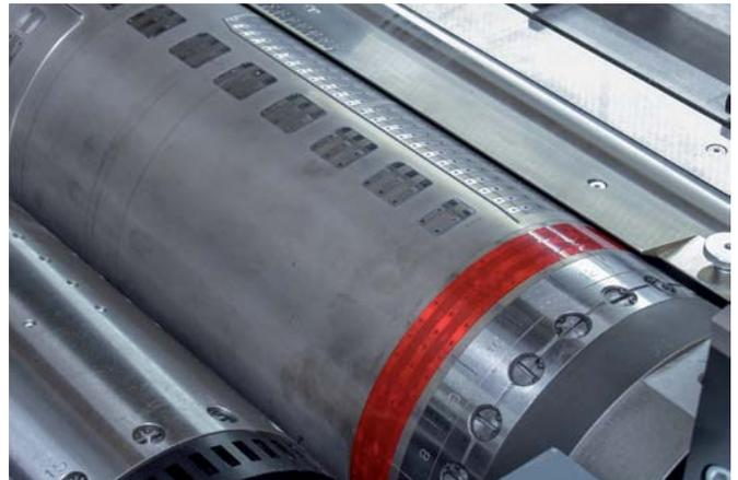
Markierte Ventilstellungen auf dem EasyCut®-Folienmesser ermöglichen einfache und schnelle Umstellungen
