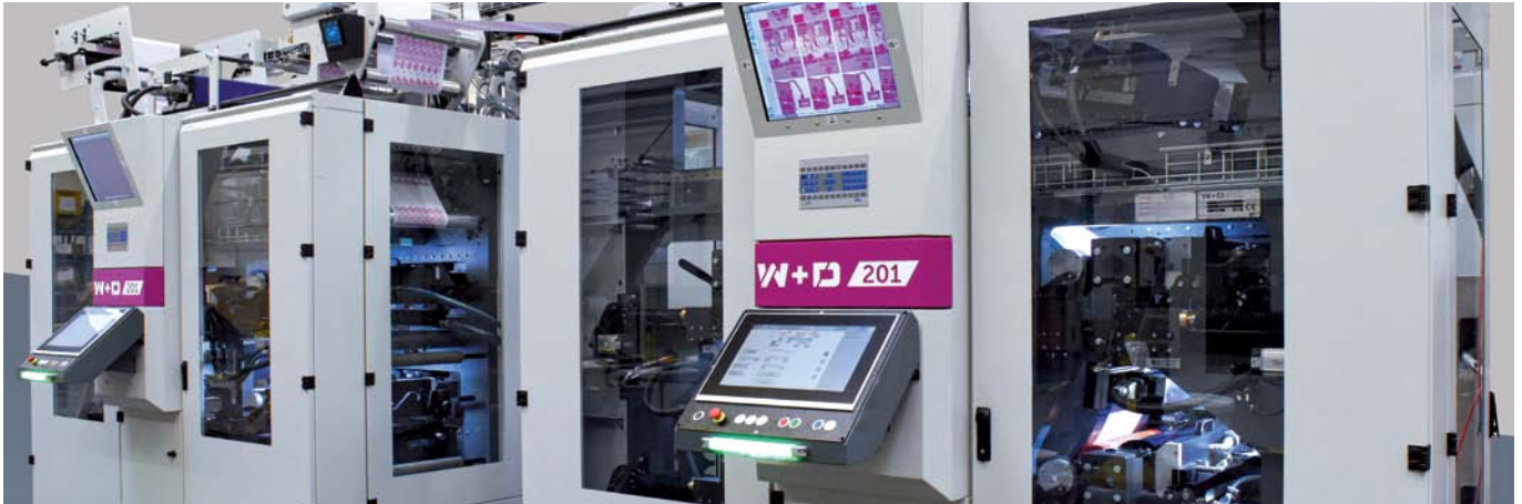
Zwei W+D 201 Inline-Flexodrucksysteme als Tandem-Kombination zur Produktion anspruchsvoller Applikationen
